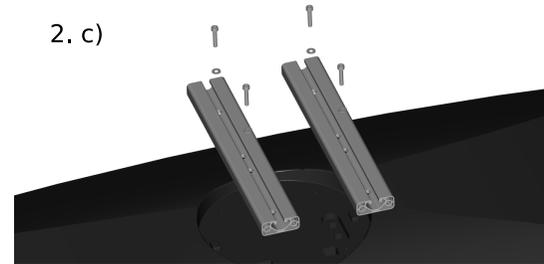
2. c) Poser l'écran sur un support (bien protégé) et connecter les 2 profilés 25 cm au VESA (75, 100 ou 200) via les trous de fixation prévus à l'aide de vis et rondelles M4.
