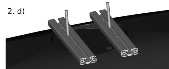
2. d) Insérer les deux tiges filetées dans les écrous des profilés (NON REPRESENTES).
