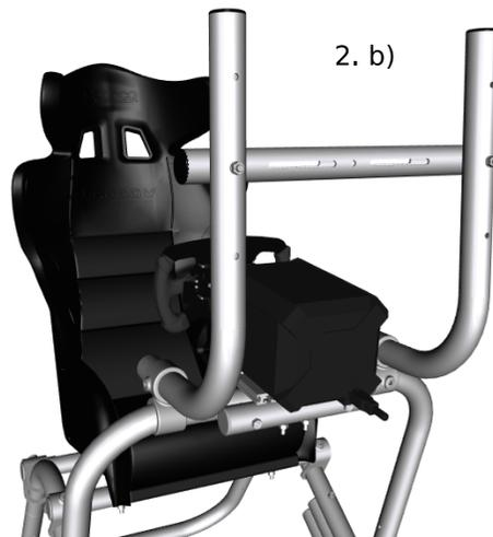
2. b) Connecter la structure au support volant via les 2 conn 8 préinsérés. Ces derniers peuvent être déplacés pour moduler l'écartement de la structure.
