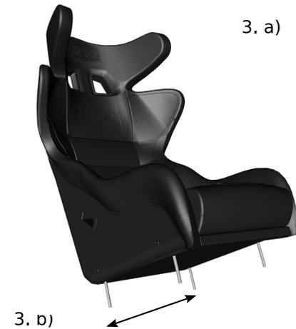
3. a) Visser les 4 tiges filetées M8\*80 dans le cas des modèles à fixation sous siège. Faire dépasser de 5-6 cm. Avec une glissière, monter d'abord la glissière sous le siège avec les vis M8 fournies, puis connecter les tiges filetées avec des écrous M8 en guise de tête de vis. Faire de même pour un siège à fixation latérale + équerres.
