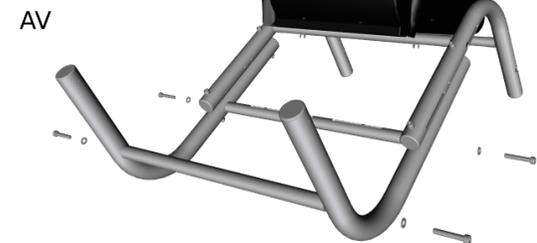
5. b) Monter le tube transversal pédalier sans rainure à l'AV de la base au niveau des trous les plus bas (GT) avec 2 vis M8x50 + rondelles.
